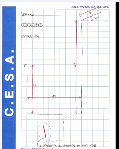
dettagli operativi di cantiere particolare del canale in rame realizzato
