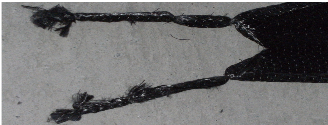
dettaglio dei fiocchi di fibra di carbonio realizzati per le cerchiature di confinamento
